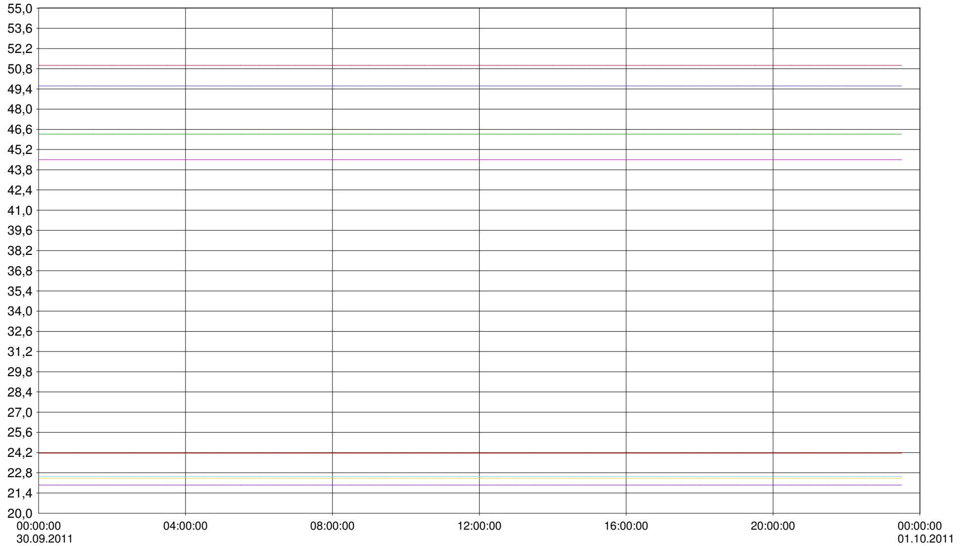
Kunstforum Raumtemperaturen in °C und Raumfeuchte in %rF
